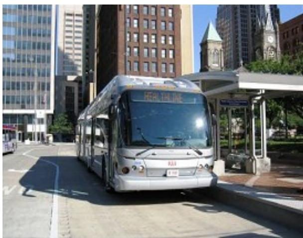
El sistema utiliza 21 buses articulados especialmente diseñados para BRT por New Flyers Industries. Estos son propulsados por un motor diesel de bajo sulfuro que provee electricidad a motores más pequeños y ecológicos.
